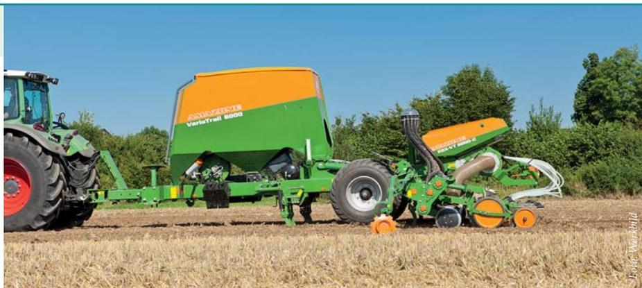
**Neue Möglichkeiten bei der Düngung: Der Düngertank Amazone VarioTrail lässt sich mit einer Einzelkornsämaschine EDX kombinieren, zukünftig auch mit einem Streifenbearbeitungsgerät.**
