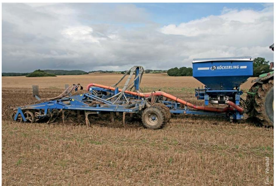
Düngerdosierer, hier aufgebaut auf einem Schwergrubber, bei der tiefen Einarbeitung von Grundnährstoffen.
